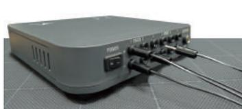
11. 加工済みのフィーダーケーブルのピンをMFC本体またはトラック拡張バック [TX] のTRACK ピンジャック IN に差し込んでご使用ください
