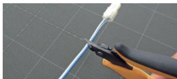
2. コネクター部分より少し下のピンクケーブルをラジオペンチ、ニッパ、ハサミ等で切ります
