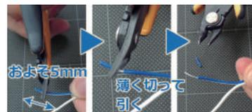
4. ラジオペンチ、ニッパ、ハサミ等を使用して被覆(ひふく)を芯線の長さをおよそ5mmになるように両端を切ってください
