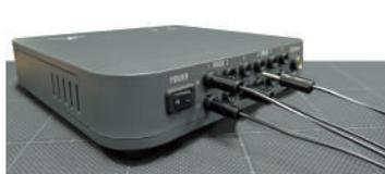
11. 加工済のポイントケーブルのピンを MFC 本体またはポイント拡張パック [PX] の POINT ピンジャック IN に差し込んでご使用ください
