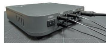
3. 専用電源 SW アダプターを DC ジャック IN とコンセントに差し込みます
