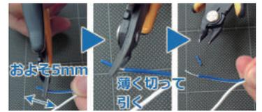
4. ラジオペンチ、ニッパ、ハサミ等を使用して被覆(ひふく)を芯線の長さをおよそ5mmになるように両端を切ってください
