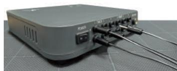
2. POINT ピンジャック IN に加工済みのポイントケーブルを差し込みます (※2)
