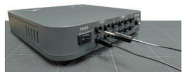
1. TRACK ピンジャック IN に加工済みのフィーダーケーブルを差し込みます (※1)
