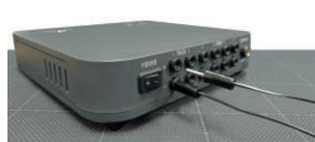
11. ピンケーブルのピンの部分をMFC本体に、フィーダー線のジョイント部分を線路に差し込んでご使用ください
